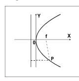
Парабола – линия, расстояние каждой точки р которой до фокуса f равно расстоянию до фиксированной прямой.
