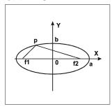
Эллипс — линия, сумма расстояний каждой точки p которой до двух фиксированных точек (фокусов) f1 и f2 постоянна и равна 2a. Каноническое уравнение эллипса:
