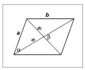
Площадь параллелограмма со сторонами a и b, углом  $\alpha$ , диагоналями  $\mathbf{d}_{_1}$  и  $\mathbf{d}_{_2}$  и углом  $\beta$  между диагоналями:
