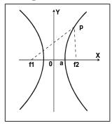
Гипербола — линия, разность расстояний каждой точки р которой до двух фокусов f1, f2 постоянна и равна 2a или -2a. Каноническое уравнение
